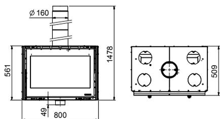
**NB:** Pour le bon fonctionnement de l'appareil, deux grilles d'aération de la bonne dimension doivent être prédisposées pendant le montage, une inférieure d'entrée et une supérieure de sortie, afin de permettre la diffusion de la chaleur dans la pièce et un refroidissement correct du produit (voir le manuel joint au produit).
